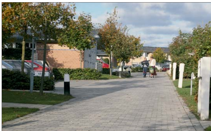
På mindre boligveje med begrænset biltrafik kan det i nogle tilfælde være fordelagtigt ikke at adskille de forskellige trafikformer og på den måde skabe et totalmiljø på de „bløde“ trafikanters vilkår. Etableret i 1993 (Sabro, Århus).
