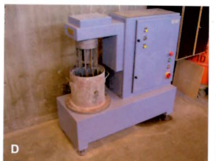
Figur 14. Forskellige metoder til kontrol og undersøgelse af SCC's bearbejdighed. (A) Udbredelsesmål, (B) J-ring, (C) L-Boks og (D) BML-viskosimeter.
