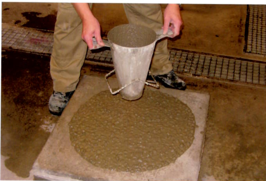
Figur 14. Forskellige metoder til kontrol og undersøgelse af SCC's bearbejdighed. (A) Udbredelsesmål, (B) J-ring, (C) L-Boks og (D) BML-viskosimeter.
